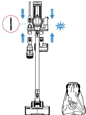
Pour éviter la déformation des poils, rangez toujours les accessoires sur la station murale après l'utilisation. Un déclic sera émis une fois l'appareil enclenché. Les pièces restantes peuvent être stockées dans le sac à outils.
