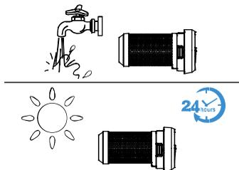
Le filtre HEPA peut être lavé à l'eau courante si nécessaire et doit être séché complètement avant de le réinstaller.
