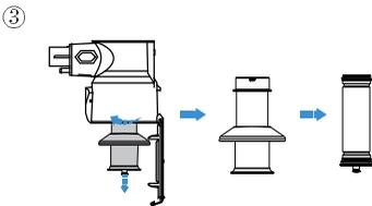
Tournez les filtres dans le sens inverse des aiguilles d'une montre et retirez-les.
