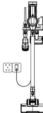
Connectez l'adaptateur à la station murale et à une prise murale électrique. Chargez la batterie installée sur le boîtier principal ou chargez-la séparément. Le double adaptateur peut charger deux batteries en même temps.
