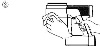
Nettoyez-le avec un chiffon humide. Ne laissez pas d'eau pénétrer dans l'appareil, surtout pas dans le moteur ni la batterie.
