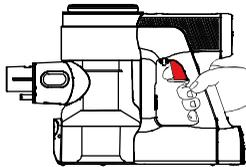
Le réglage par défaut est le mode AUTO après le démarrage de l'appareil; il mettra 3 secondes pour vérifier s'il y a un blocage puis il détectera la quantité de poussières. Si aucune poussière n'est détectée, la puissance sera réduite à la puissance moyenne.
