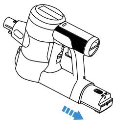
Appuyez sur le bouton de déverrouillage de la batterie, puis retirez la batterie.
