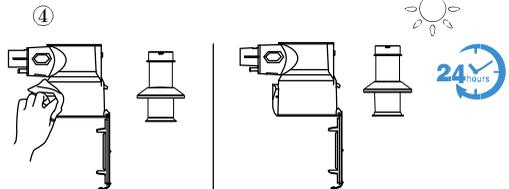
Nettoyez le bac à poussières et le filtre à mailles avec un chiffon humide. Les deux pièces doivent être complètement séchées à l'air avant de les remettre en place.
