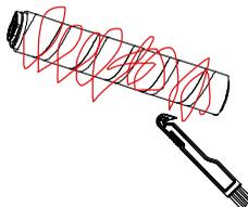
Enlever les poils et les débris enroulés autour du rouleau, avec l'outil de nettoyage pour brosse.
