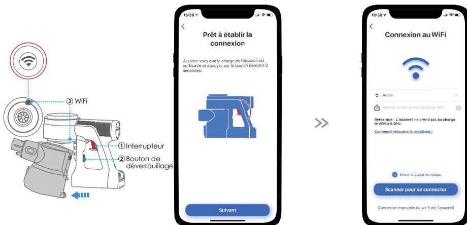
Assurez-vous que l'appareil est suffisamment alimenté et appuyez sur l'interrupteur pendant 2 secondes pour l'activer. Appuyez sur le bouton de déverrouillage pour retirer le bac à poussières, appuyez et maintenez le bouton de réinitialisation Wi-Fi pendant 2 secondes et attendez la connexion.
