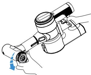
Activez l'appareil en mode MAX et faites pivoter le couvercle latéral pour nettoyer le pré-filtre. Retirez ensuite le filtre pour la sauvegarde après le nettoyage.
