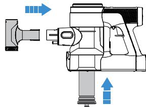
Veillez éteindre l'appareil avant le nettoyage et sortez le pré-filtre encrassé du porte-filtre en treillis.
