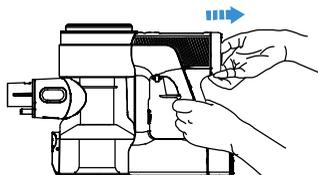
Appuyez sur le bouton de déverrouillage du filtre HEPA et retirez-le doucement pour le nettoyer.
