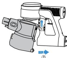
Inclinez le bac en plaçant la fente du bac vers le crochet du boîtier principal. Poussez vers le haut jusqu'à ce que le crochet se fixe dans la fente. Un déclic sonore sera émis lorsqu'il sera solidement verrouillé.
