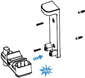
Assemblez les deux parties de la station, un déclic sonore sera émis quand il sera enclenché. Installez ensuite la station au mur avec les clous fournis par Tineco.
