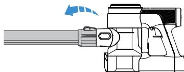
Appuyez sur le bouton de déverrouillage et retirez le tube.
